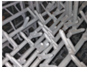
Balancelles décapées par pyrolyse, finition par grenaillage.
